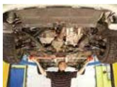
車両が水平にセッティングされているか、最初に確認してください。
